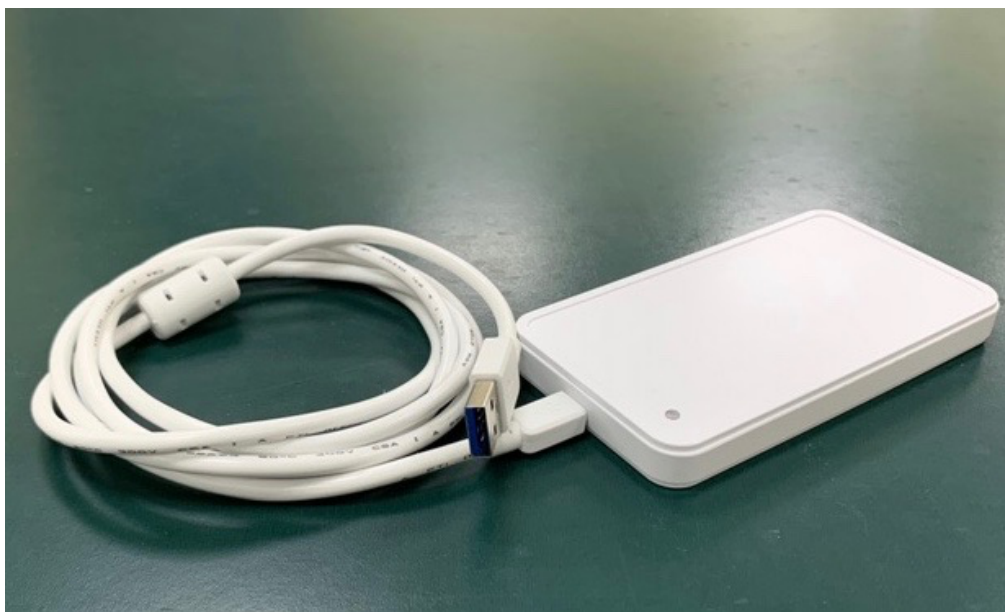
Рис.1 Внешний вид считывателя UEM Mifare/ICode/NFC USB reader V9.0.
