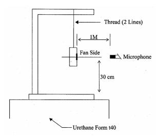
1 METER FROM MICROPHONE TO FAN INTAKE
