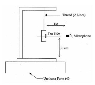
1 METER FROM MICROPHONE TO FAN INTAKE
